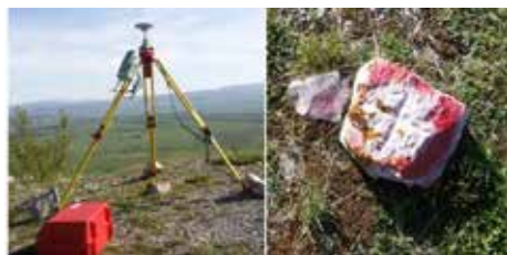
Slika 5. Brza statička metoda – antenski prijamnik ATX1230GG na T30
