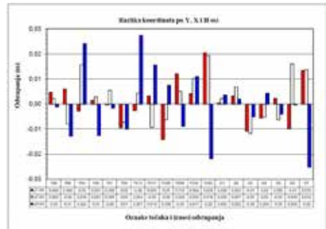
Slika 14. Grafički prikaz razlike koordinata točaka po pojedinim osima (Y,X,H), brza statika s prisilom i FBIHPOS (VPPS)
