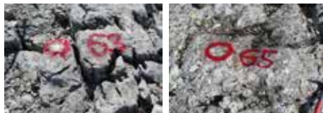
Slika 3. Novo-uspostavljene GNSS točke G3 (lijevo) i G5 (desno)
