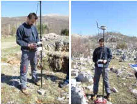
Slika 6. RTK opažanja uz primjenu FBIHPOS - T88 (slika lijevo) i G2 (slika desno)
