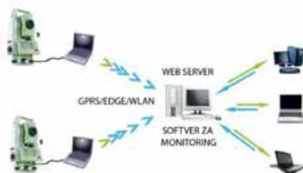
Slika 7. Plan monitoring sustava (Akpinar 2015)
