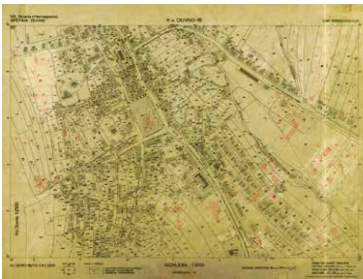
Slika 9. Katastarski plan izrađen aerofotogrametrijskom metodom
