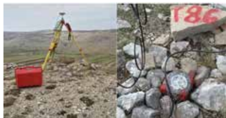
Slika 4. Brza statička metoda mjerenja – bazni prijamnik AX1202 GG na T86
