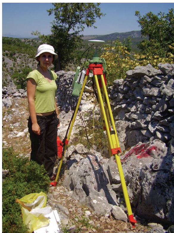
Slika 10. Postavljena baza sustava GPS na točki KRBI
