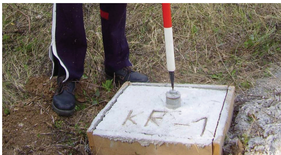
Slika 12. Kontrolno snimanje pjezometra KR-1 u prostoru pregrade MHE Kravice
